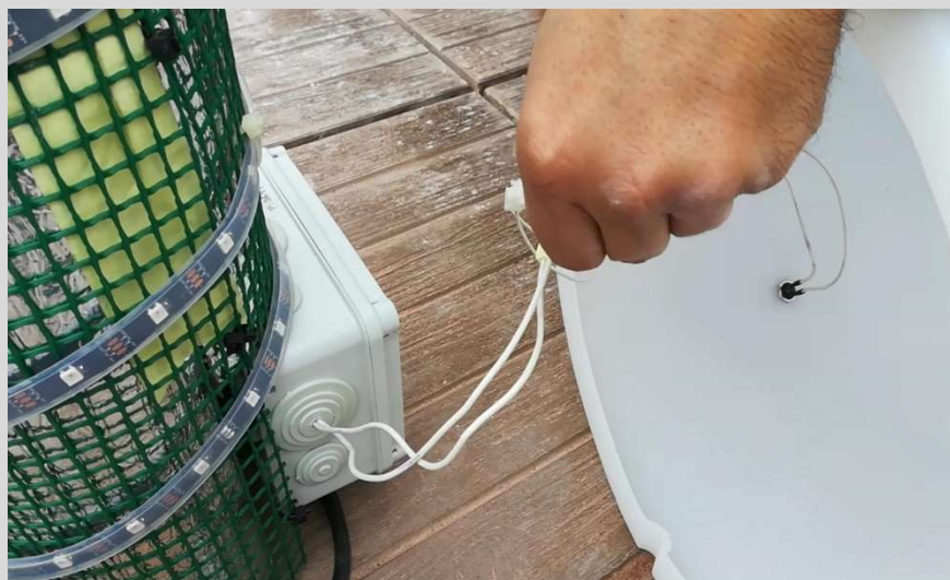
Ilustración 8. Retirar cable del interruptor
