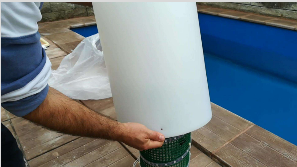
Ilustración 11. Volver a colocar el cilindro decorativo
